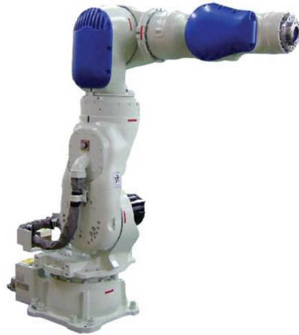
Figura 18. Robot con el cableado mínimo necesario.
