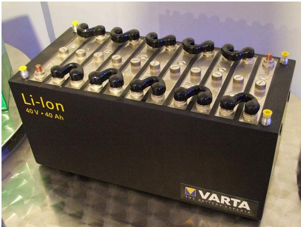
Figura 5. Batería Electroquímica de Litio-Ión.
