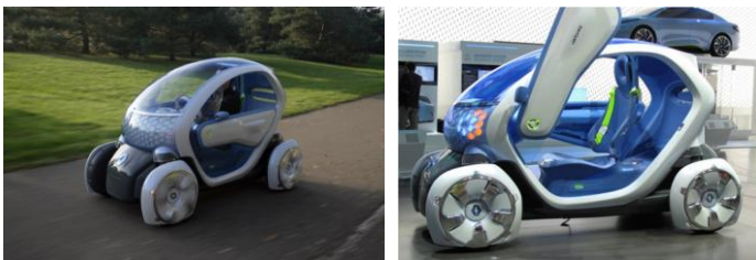
Figura 11. Renault Twizy Z.E. Biplaza con los asientos en línea y no en paralelo. Se espera su comercialización en España en Diciembre de 2011.
