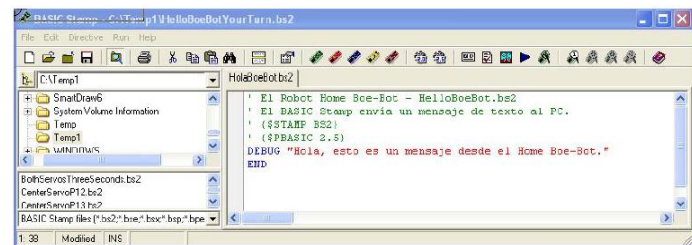
Figura 3. Prueba de comunicación con el robot del kit Home BoeBot.
