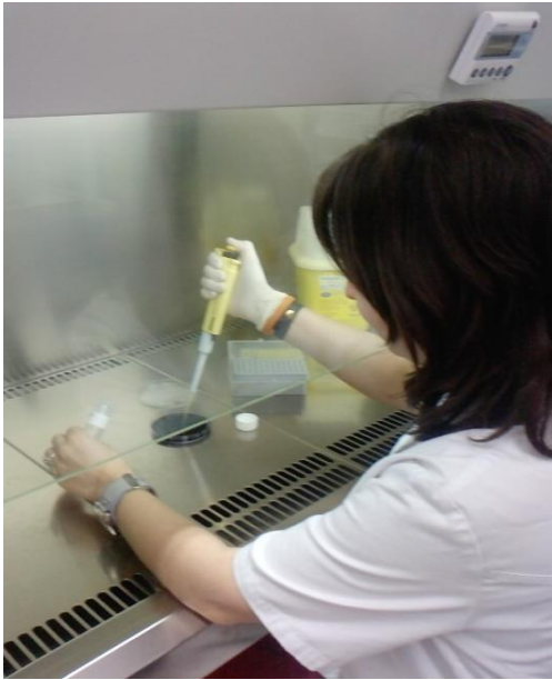
Figura 4. Preparación de diluciones de las muestras y siembra en agares específicos para el desarrollo de la bacteria en la campana de flujo esterilizando el medio.
