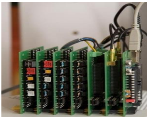
Figura 9. Una matriz con 4 tarjetas de componentes, una de DMM, una de osciloscopio y una de controlador
