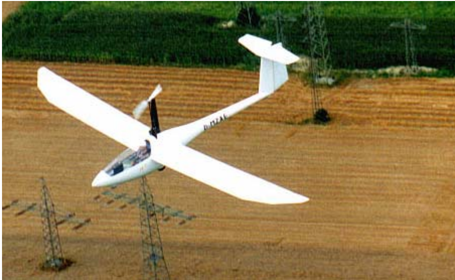
Figura 5: AE-1, motovelero eléctrico con baterías
